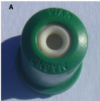
FOTO 4.2. Boquilla de aire inducido A) Aire inducido / B) Convencional
