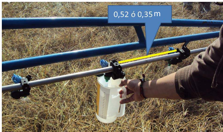
FIGURA 4.6. Determinación del distanciamiento entre picos en metros (m)
