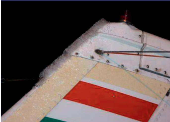
Hielo en superficies aerodinámica de pequeño radio de curvatura
