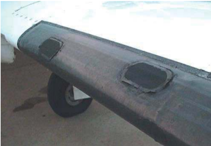
Bota de deshielo con parches de reparación
